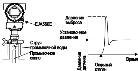
Рисунок 6. Прямой промыв датчика с использованием промывочной насадки
